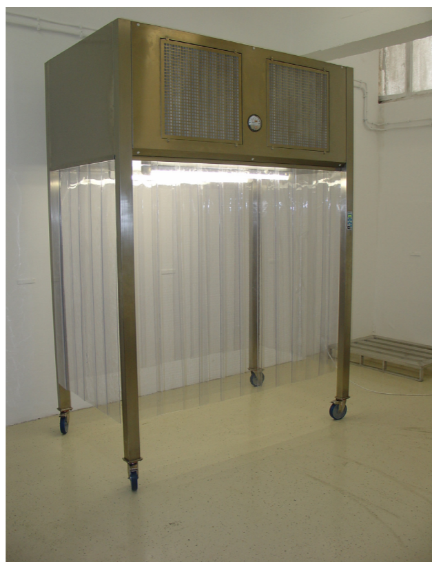
Stojeća izvedba kabine za rad u čistom
